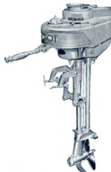
N° 2 - Moteur GOIOT Puissance 3 CV. \frac{1}{2} Poids : 20 kgs. Consommation 1 l. \frac{1}{2} heure
