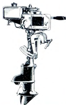
N° 2 - Moteur GOIOT Puissance 3 CV. \frac{1}{2} Poids : 20 kgs. Consommation 1 l. \frac{1}{2} heure
