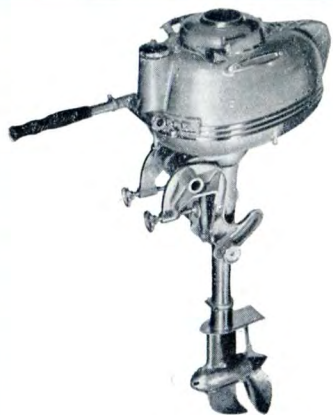
N° 1 - Moteur GOIOT, type Colonial Puissance 7 CV. Poids : 35 kgs. Consommation 2 l. heure
